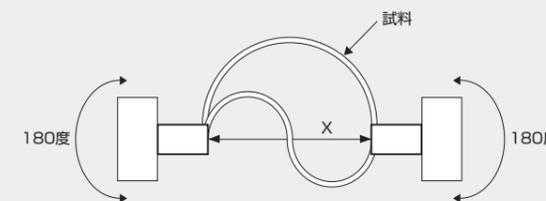
曲げ速度：20回/分 捻回角度：左右180度 (合計360度捻回)
