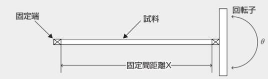
曲げ速度：60回/分 捻回角度：左右90度 (合計180度捻回)
