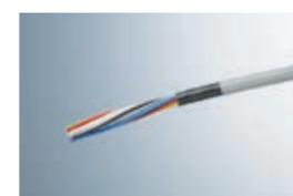
薬品対策で幅広く使用されているフッ素樹脂ですが、ケーブルとしては硬くて取扱い難いものとなっております。しかしPVCシースの上に最低限の厚みでフッ素樹脂を被せることにより、フッ素樹脂ケーブルよりも扱い易くしました。
