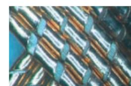
ロボットケーブルにて通常最初に断線するのがシールド部になります。装置の高速化・コンパクト化にて配線条件がより厳しい環境下において通常のTA編組シールドに代わる超屈曲シールドを提案します。
